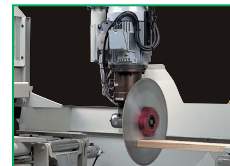
間柱ほぞ取りカッター(オプション) 間柱の切断、ほぞ取り加工を、丸鋸とカッターを組み合わせたひとつの刃物ユニットで同時に行います。(本ユニット使用時は、ボーリング錐ユニットを使用できません。)
