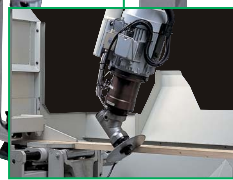
筋違い欠き丸鋸 間柱に筋違い欠き加工を行っています。他に隅木の乗せ継ぎオス加工にも使用します。
