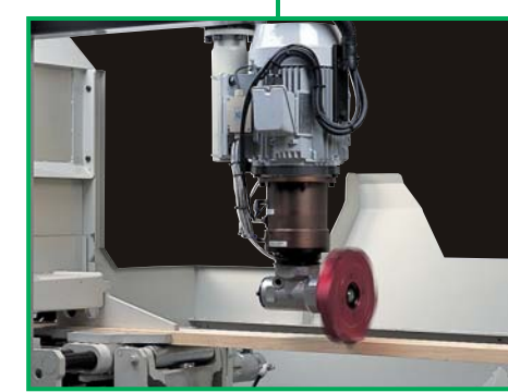
間柱欠きカッター 窓台、まぐさ、間柱欠き加工を行っています。他に間柱のほぞ加工、根太の相欠き加工等にも使用します。
