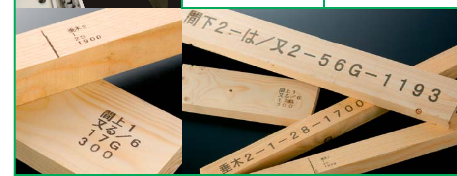
印字装置(MIP型) 加工材の取り出し時に、部品名称・番付・全長等を印字します。解像度が高い機種を採用し、小さな文字や多くの情報の印字が可能で、小さな部品にも鮮明に文字を印字することができます。
