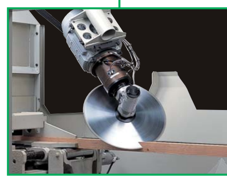
丸鋸 垂木の三次元角度切断を行っています。これ以外のすべての切断加工にも使用します。
